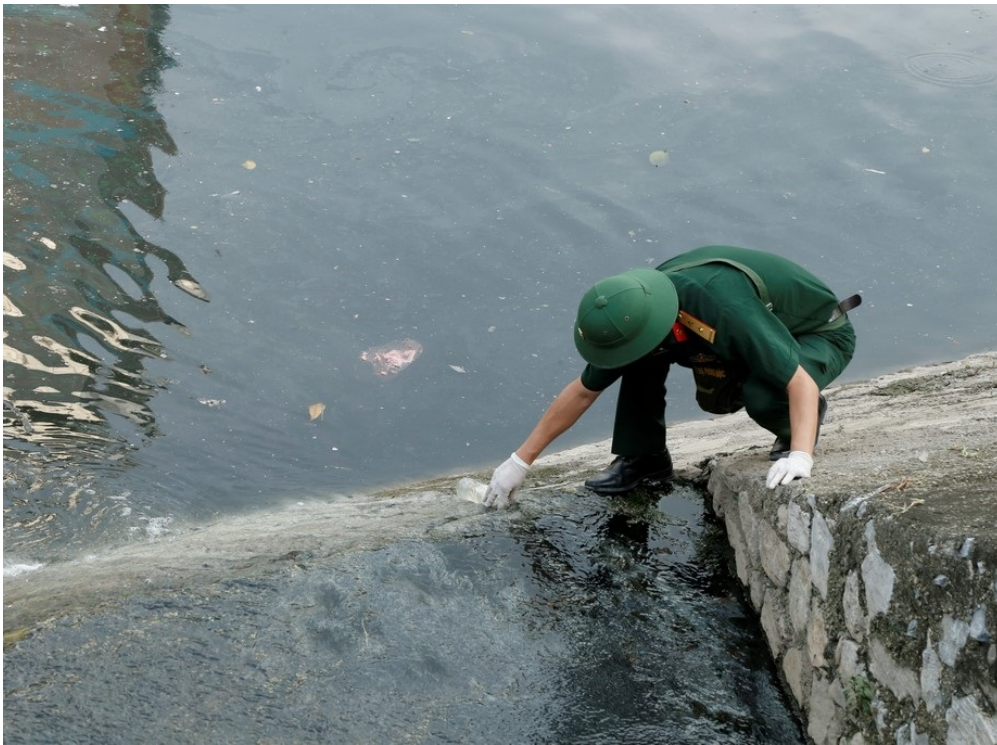
Lấy mẫu nước để xác định nồng độ thủy ngân trong nước. Nguồn: Bình chủng hóa học,
