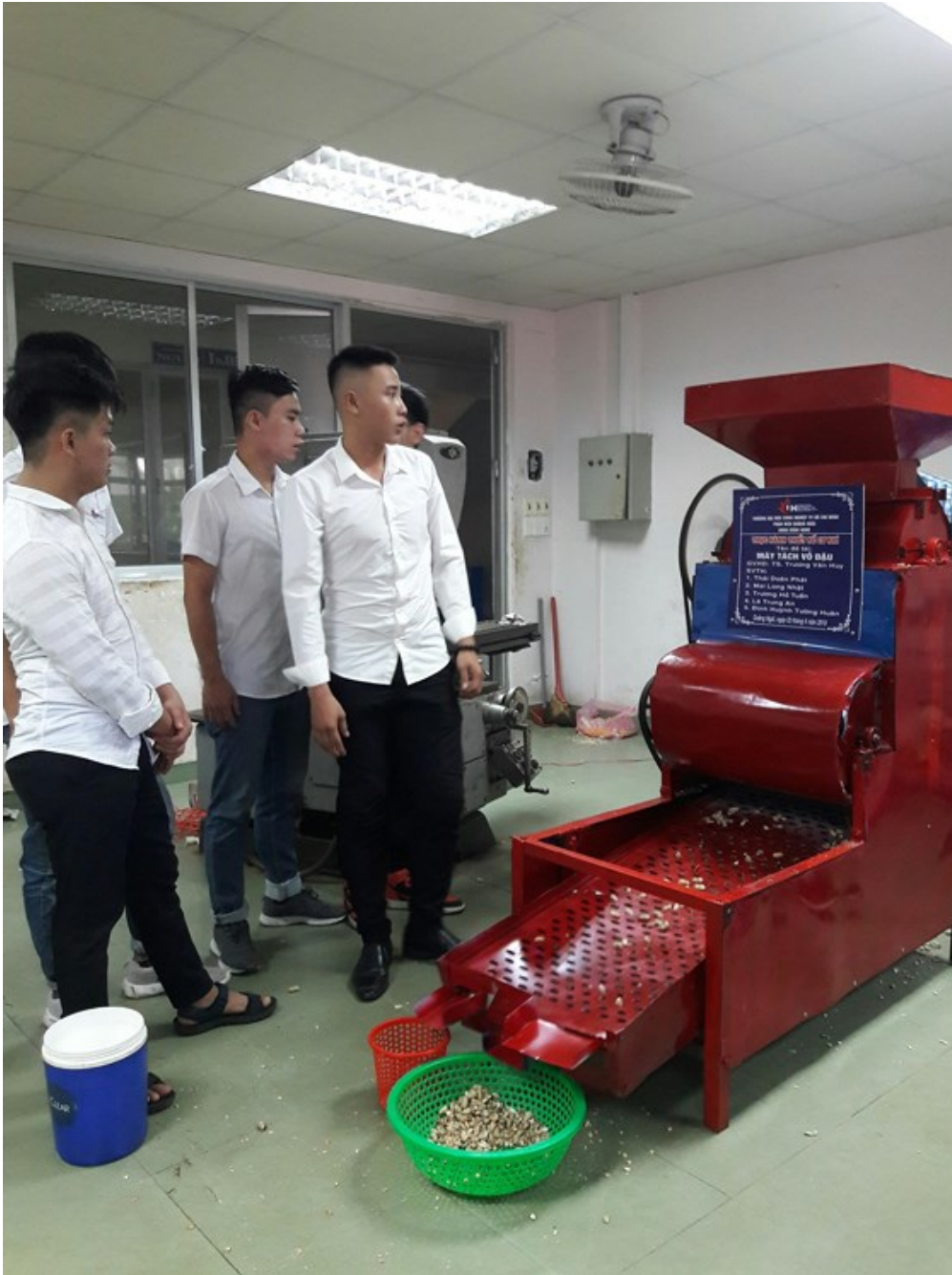
Máy tách hạt đậu phộng với chi phí đầu tư chỉ 3,2 triệu đồng. Ảnh: NGUYỄN TRANG.
